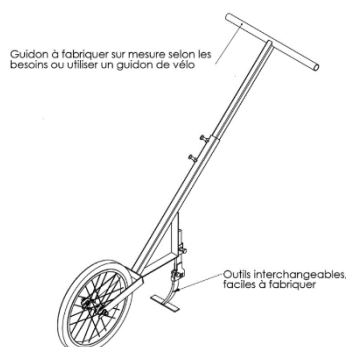
Figure 6.1 : Prototype de houe maraichère conçu par la coopérative l'atelier paysan
